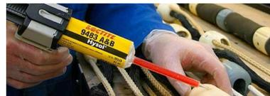
**Sellado:** Sellar las roscas o las bridas en las tuberías, las cajas de cambios u otras piezas industriales, previene fugas de todo tipo.
