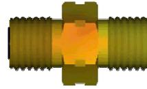
La gama de racorería para tubo rígido ORFS (**O' Ring Face Seal**) se ha diseñado para eliminar las fugas en los sistemas hidráulicos, y, al mismo tiempo, permitir presiones de trabajo más elevadas. Estos racores se caracterizan por un cierre hermético plano, mediante una junta tórica en el racor. Fabricación en acero al carbono e inoxidable.
