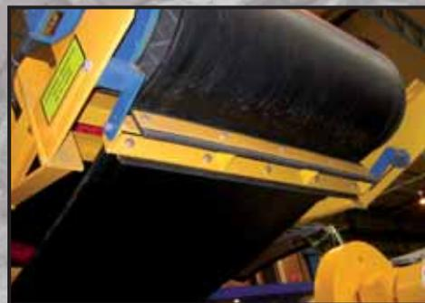
**Tensor ROSTA «SE» para Rascador de Banda:**
